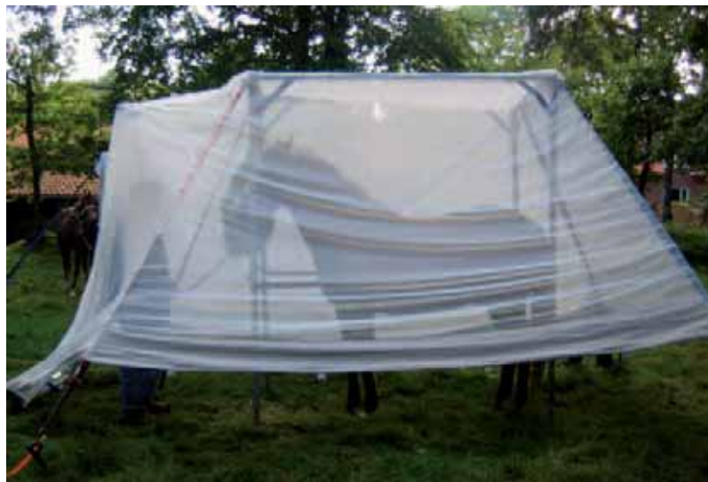
Vangkooi die is ontwikkeld voor het vangen van muggen bij paarden.
